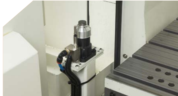
> PRESSETER (SETUP E CORREÇÃO DO DESGASTE DA FERRAMENTA)
