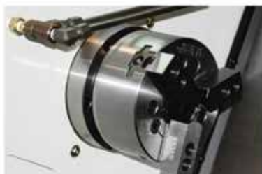
Soprador de ar da placa
